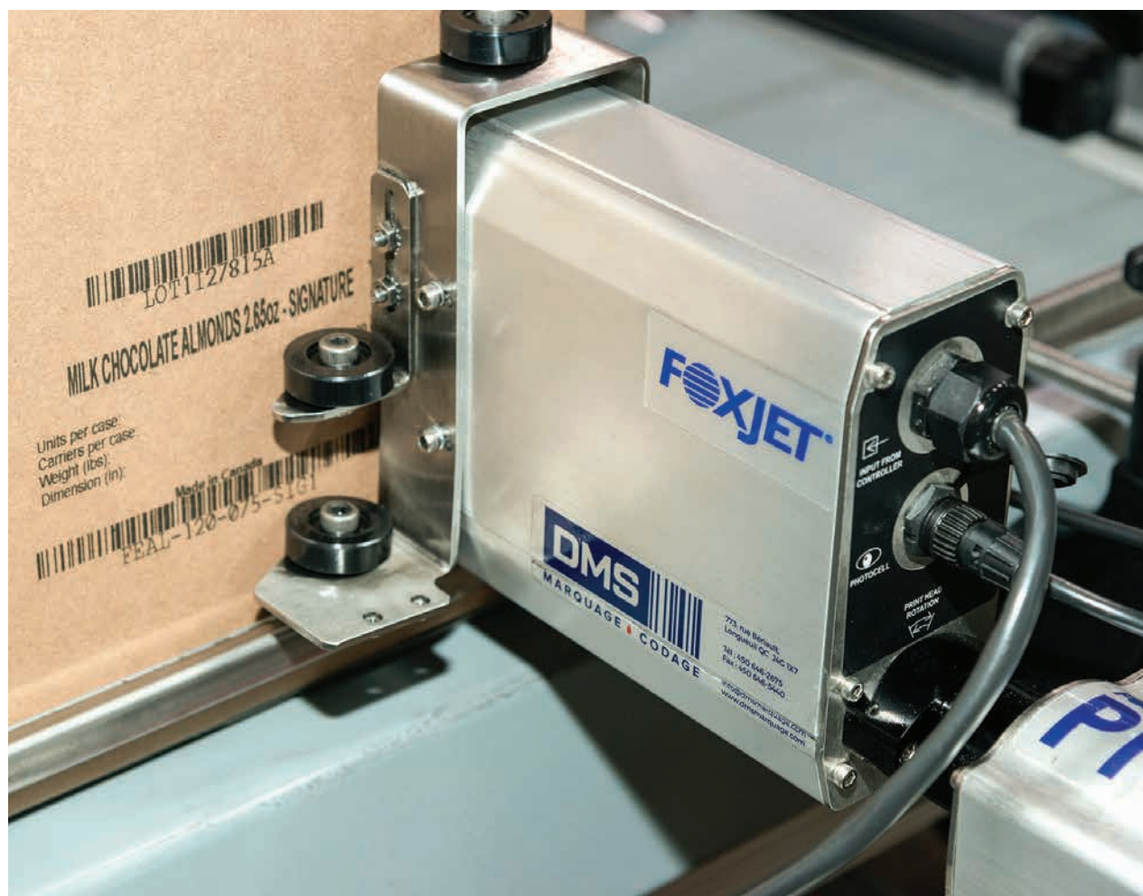
L'une des quatre imprimantes à jet d'encre haute résolution de marque FoxJet que DMS Marquage Codage a fournies à Chocolat Lamontagne.
