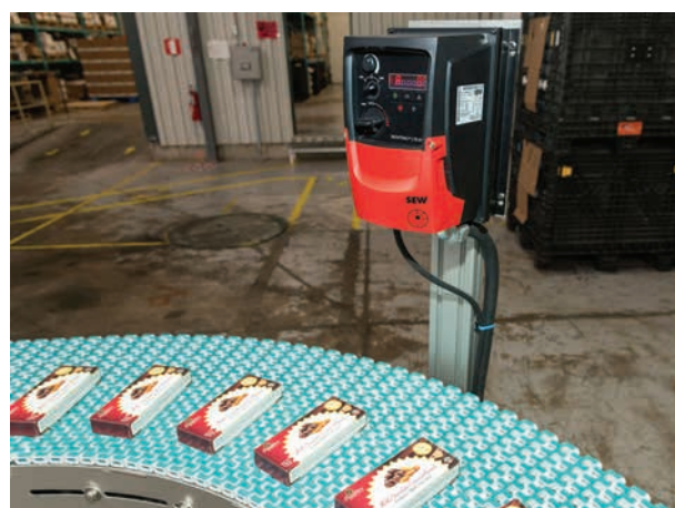
Une unité provenant de SEW-Eurodrive assure les mouvements de convoyeurs.
