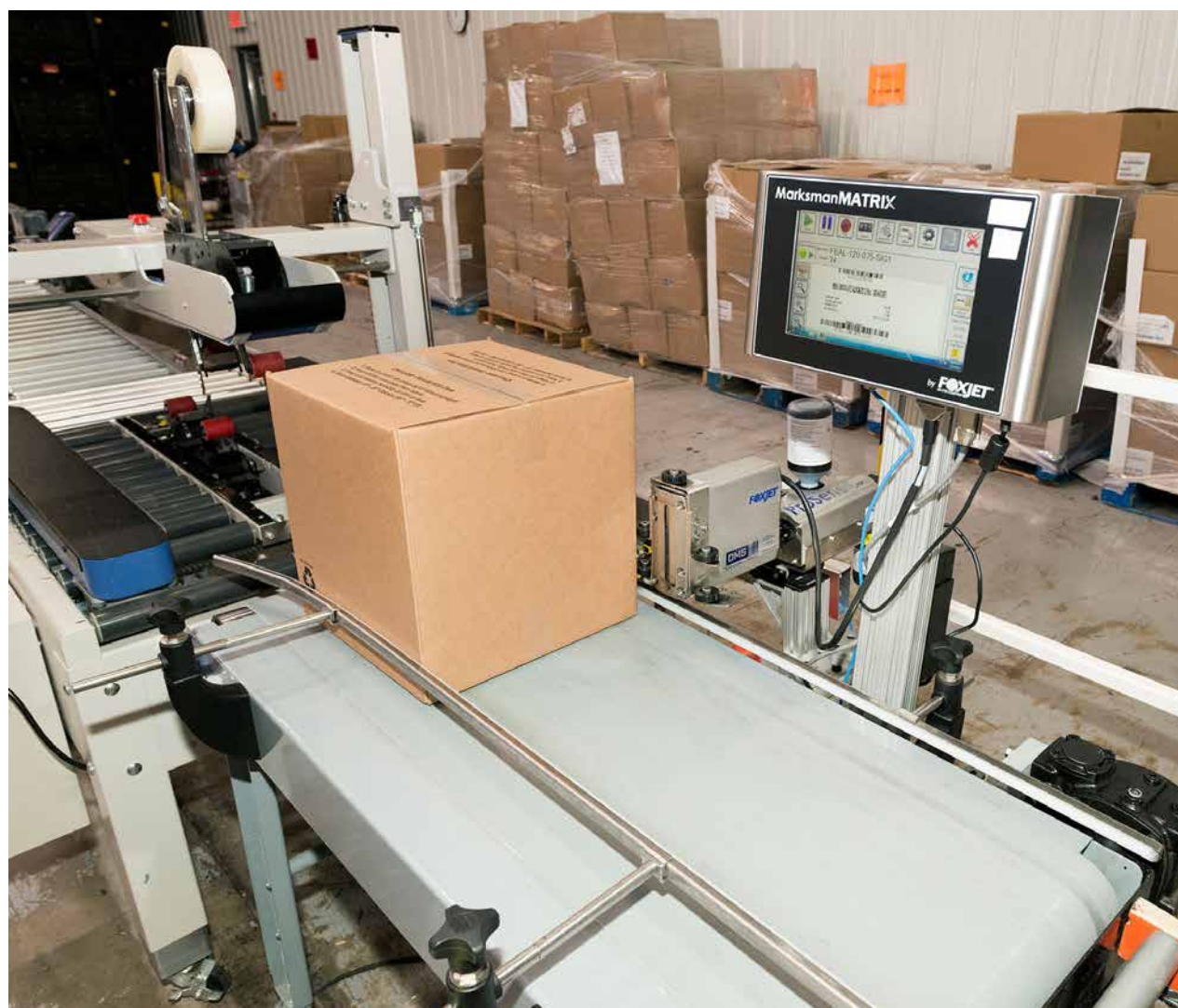
Les imprimantes à jet d'encre haute résolution de marque FoxJet fournis par DMS Marquage Codage sont dotées d'un contrôleur Marksman Matrix.
